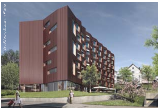
Kompakte Gebäudehülle, zur Sonne ausgerichtete Fenster, Holzpellet-Heizung: Das Altersheim Trotte.
